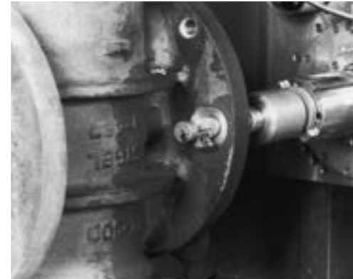
Lamage en tirant sur un corps de vanne
