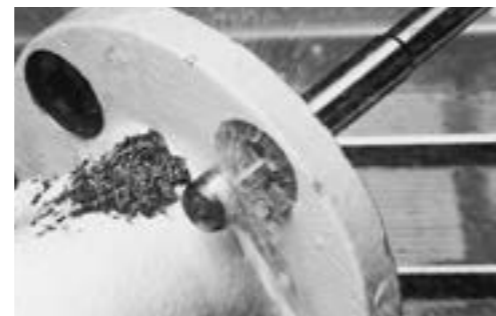
Lamage avec arrosage central
