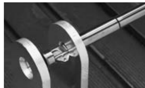
Chanfreinage en poussant en tirant 45°
